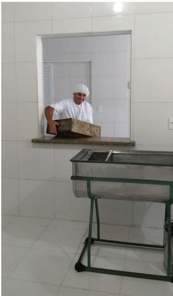
Figura 40. Quadros sendo transferidos através dos “óculos” evitando assim contaminações dentro da área de extração
