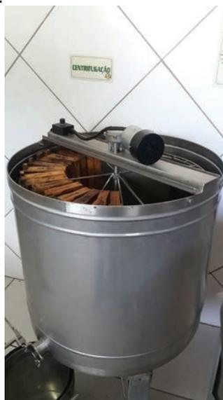
Figura 36. Para produções acima de 30 colmeias justifica-se a utilização de centrífuga elétrica pela diminuição de mão de obra
