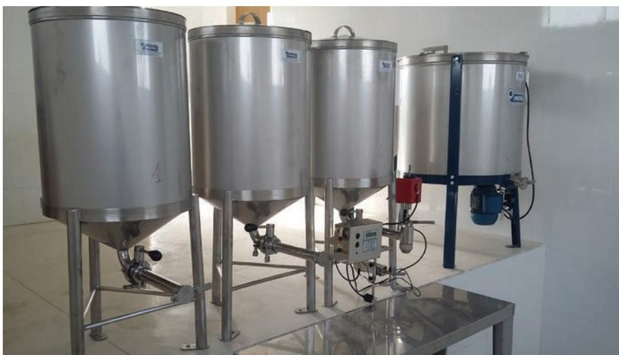
Figura 38. Tanque decantador com torneira para envase a granel
