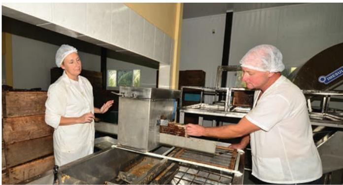
Figura 33. A máquina desoperculadora agiliza o trabalho na extração do mel
