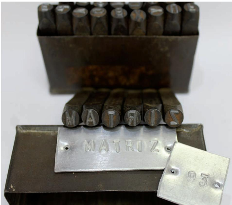
Figura 2. Punções utilizados para a gravação de letras e números para a identificação de colmeias.
