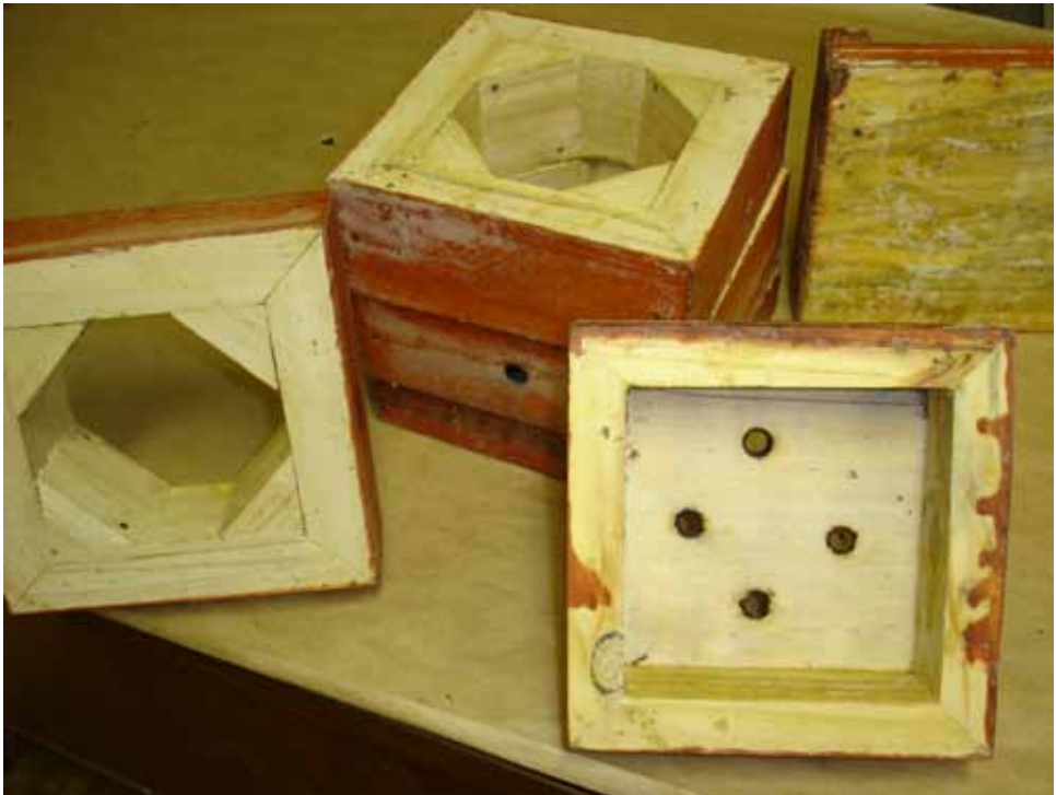
Figura 22. Partes de uma caixa (modelo vertical)
