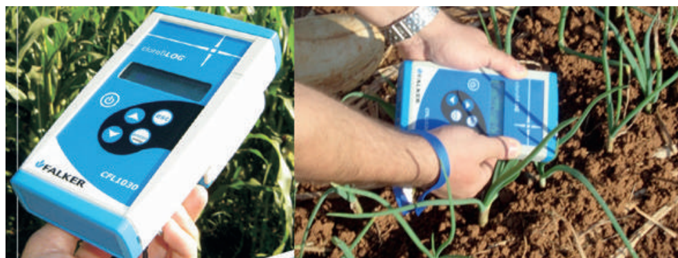
Figura 15. Clorofilômetro portátil utilizado nas avaliações na Estação Experimental de Ituporanga, Modelo CFL 1030 ClorofiLOG da marca Falcker
