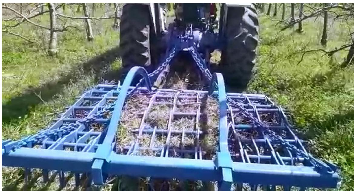
**Figura 2:** Implementos agrícolas desenvolvidos para retirada dos restos de poda do pomar.
