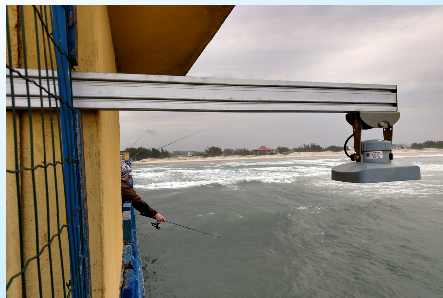
Marégrafo de Balneário Rincão – Plataforma de Pesca
